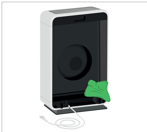
Fig. 17: Nettoyage du boîtier de filtration
